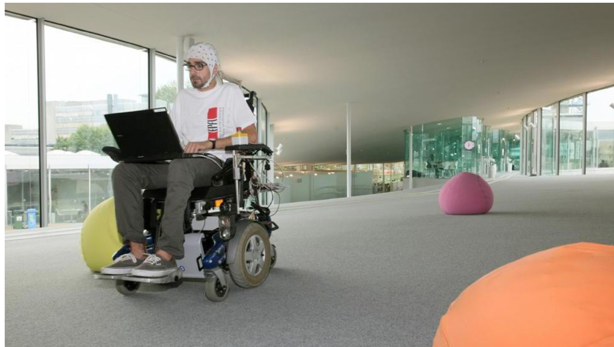
Invalidska kolica kontrolirana sučeljem mozak-računalo izvor: EPFL, www.epfl.ch
